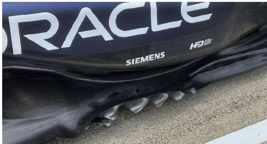
Imatge 24. Generador de vòrtex del RB20. Extreta de: Motorsport.com
