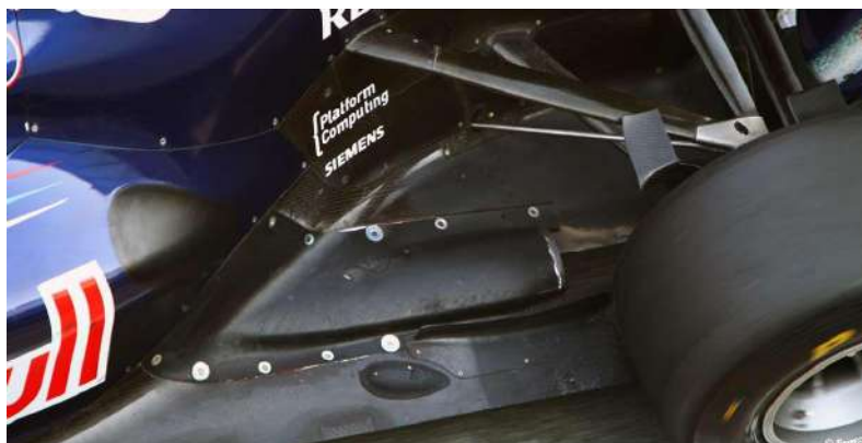
Imatge 32.. Tub d'escapament bufat. Extreta de: Car and Driver
