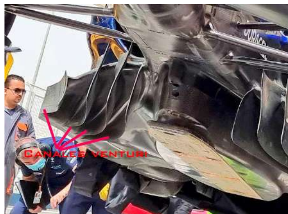
Imatge 21. Canals de Venturi. Extreta de: SoyMotor.es
