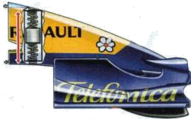
Imatge 30. Il·lustració del mass dumper. Extreta de: F1 Dictionary
